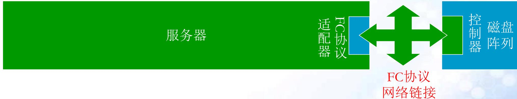
实现了用网络连接存储设备，并在网络上传输磁盘数据，
