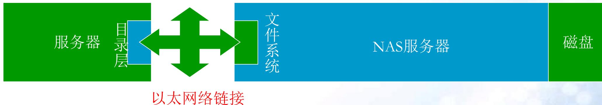
改变了存储系统对主机的依赖，也就是解放了主机，使宝贵的主机资源可以专心去做业务，底层的存储处理逻辑有存储设备自己完成。
