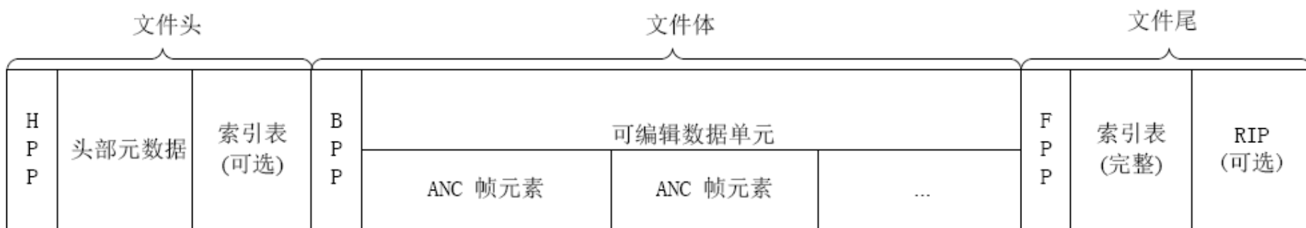
图8 包含AFD信息的独立的MXF文件结构
